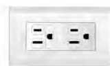
Dual Grounding Socket - Locked Wire 基本款接地雙插座-鎖線式 JY-M1510VN-LI AC 15A/125V Φ1.6 2.0銅導體 3.5mm 2 5.5mm 2 絞線
